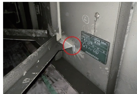
磁気探傷試験（鋼桁ガセット溶接部に発生した疲労き裂）
