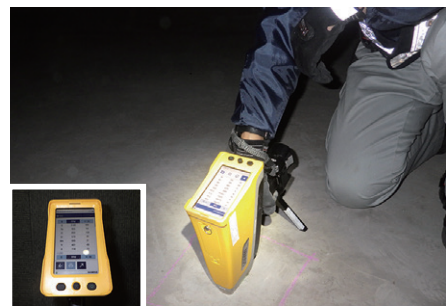
蛍光X線分析による塩分量測定
