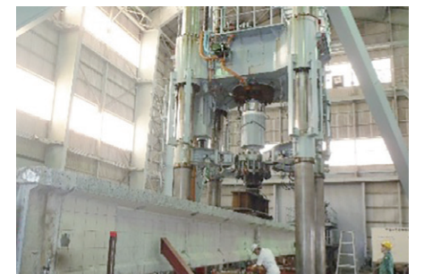
撤去した PC 桁の載荷試験
