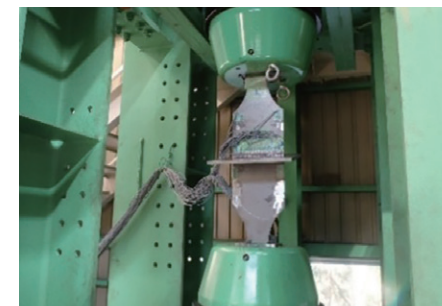
溶接継手部の疲労試験
